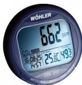
Fig. 12 Registrador Wöhler CDL 210 (T, HR y CO 2 )
